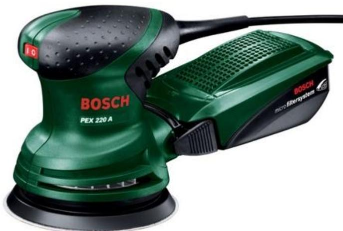
**Lijadora orbital o vibratoria:** La lijadora excéntrica se basa en un movimiento elíptico de la base donde se asienta la lija. (Ver figura N° 62 y 63) En algunas se puede variar el tipo de movimiento, y las mejores tienen un movimiento orbital aleatorio, con lo que los posibles arañazos pasan más inadvertidos. Se utiliza para lijados no muy bastos y sobre todo para acabados muy finos. Se deben dar pasadas paralelas y Súper puestas hacia delante y hacia atrás.
