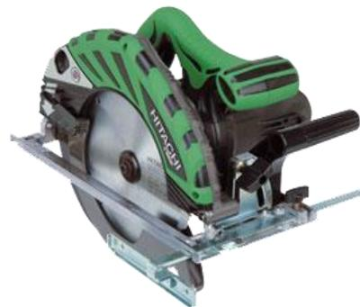
**Partes de la sierra:** Estas máquinas están dotadas de carcasas de protección, que protegen al usuario de cualquier contacto con el disco de rotación. También llevan un interruptor de seguridad. La base inclinable graduada en grados permite cortes sesgados de 0 a 45°. También va equipada con una guía de corte paralelo, graduada en mm. Algunos modelos incorporan sistemas complementarios como bolsa para serrín y Adaptador a una aspiradora.
