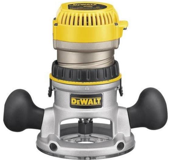
**Partes de la ruteadora:** La ruteadora está formada por un sistema de columna de resorte que aguanta la caja motor hacia arriba. Con los dos mangos laterales haremos subir y bajar la caja motor hacia la pieza de madera. El motor gira un eje central en el que van fijas las fresas o cuchillas.
