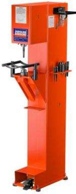
**Remachadora T-Columna:** Su peso es de más de 100 kg, y también cuenta con un pedal pero de accionamiento neumático. Estas máquinas utilizan aire comprimido, con válvulas que nos permiten regular las presiones en el trabajo, el consumo de aire por hora, etc. Los remaches que se pueden utilizar con este tipo de remachadora son de aluminio, cobre, acero inoxidable y latón.
