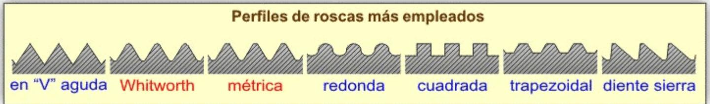
Las roscas en "V" aguda suelen emplearse para instrumentos de precisión (tornillo micrométrico, microscopio...); la Witworth y la métrica se emplean para sujeción (sistema tornillo-tuerca); la redonda para aplicaciones especiales (las lámparas y portalámparas llevan esta rosca).
